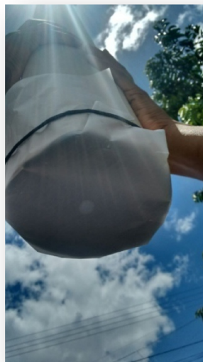
Figura 8: Câmera escura para medir o diâmetro do Sol
