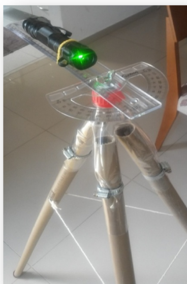
Figura 5: Teodolito caseiro feito de pvc
